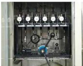
Equipo para ensayo de creep
