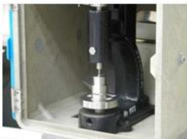
Prensa para fabricación de probetas de ensayo
